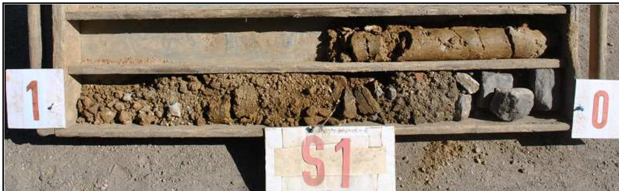
Obr.č. 2 : Pohled do vzorkovnice na geologický profil sondy S1, hluboké 1,4 m. Konstrukce cesty je složena z penetračního makadamu a lomové štěrkodrtě frakce 0-125 souhrnné mocnosti 250 mm (rozpojeno sbíjením) . Spočívá na hlinito-písčitém deluviu, soudržném, pevné konzistence, s úlomky až kameny do vel. 5 cm. Podzemní voda se v sondě neprojevila.
