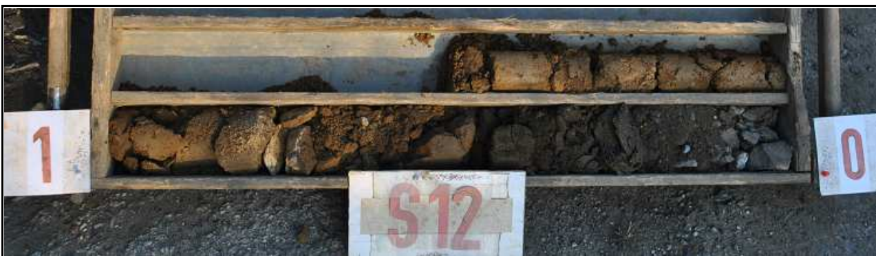
Obr.č. 24 : Pohled na geologický profil sondy S12, hluboké 1,5 m. Konstrukce cesty je složena ze slabě degradované vrstvy penetračního makadamu s podsypem ze štěrkovitého písku, mocnosti 0,3 m. Založena je do tmavě šedého písku, drobně úlomkovitého (původní cesta) , od 0,4 m s přechodem do hlinitého písku s úlomky a kameny do vel. 8 cm. Od hloubky 1,2 m zastíženo rulové eluvium, ulehlé, třídy R6
