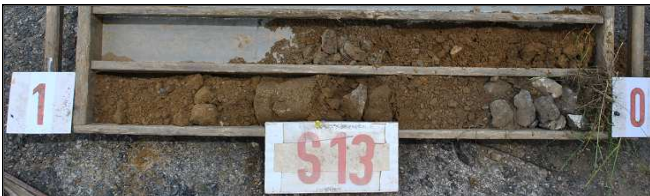
Obr.č. 26 : Pohled na geologický profil sondy S13, hluboké 1,5 m. Na okraji zastížen mezerovitý penetračního makadam tl. 200 mm s podsypem z tmavě hnědošedého štěrkovitého písku. Od úrovně 0,35 m dokumentován hlinitý písek s úlomky a kameny do vel. 5 cm, přecházející v hloubce 1,4 m do zcela zvětralé pararuly třídy R6-R5. Podzemní voda se v sondě neprojevila.
