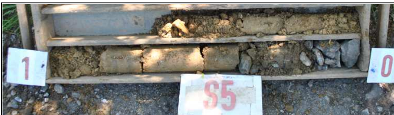
Obr.č. 10 : Pohled na geologický profil sondy S5, hluboké 1,6 m Konstrukce cesty je složena ze silně degradované vrstvy penetračního makadamu s podsypem ze štěrkodrtě 0-32 založené do tmavě šedého štěrkovitého písku , s úlomky cihel (původní povrch cesty) souhrnné mocnosti 0,4 m (rozpojeno sbíjením). Spočívá na vrstvě hnědošedého hlinitého písku , pevné konzistence, s úlomky, od hloubky 0,9 m s přechodem do eluviálně rozvětralého rulového podloží, třídy R6. Hloubení ukončeno ve zcela zvětralé pararule, třídy R6-R5. Podzemní voda se v sondě neprojevila.
