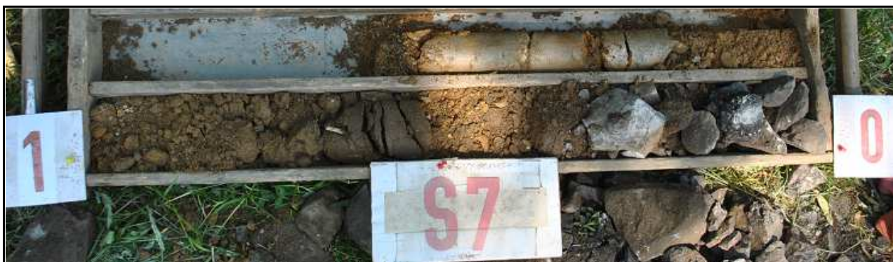
Obr.č. 14 : Pohled na geologický profil sondy S7, hluboké 1,6 m. Konstrukce cesty je složena ze slabě degradované vrstvy penetračního makadamu s podsypem frakce 0-125 založené v úrovni 0,4 m do tmavě šedého štěrkovitého písku, s úlomky cihel (původní povrch cesty – do hloubky 0,5 m rozpojeno sbíjením). Spočívá na vrstvě hnědého hlinitého písku s kořeny, pevné konzistence, s úlomky, od hloubky 1,0 m s přechodem do slídnato-písčitého eluvia třídy R6. Hloubení ukončeno ve zcela zvětralé rule třídy R6-R5. Podzemní voda se v sondě neprojevila.
