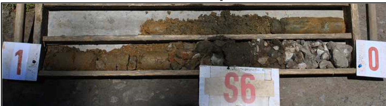
Obr.č. 12 : Pohled na geologický profil sondy S6, hluboké 1,7 m. Cesta je v daném úseku vedena po násypu výšky 0,6 m , od úrovně 0,35 m štětovaném (obtížně sbíjeno). Násyp spočívá na vrstvě hlinitého od hloubky 1,0 jílovitého písku, pevné konzistence, na bázi písek slabě jílovitý, středně ulehlý. Hloubení ukončeno v horninovém eluvium třídy R6. Vrt zalila povrchová akumulace v úrovni 0,4 m.
