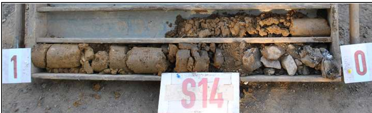
Obr.č. 28 : Pohled na geologický profil sondy S14, hluboké 1,5 m. Konstrukce cesty je složena ze slabě degradované vrstvy penetračního makadamu s podsypem z lomové frakce 0-125 mocnosti 0,25 m. Založena je do tmavě šedého písku, drobně úlomkovitého, cihly (původní cesta) , od 0,35 m s přechodem do hlinitého písku s úlomky a kameny do vel. 4 cm. Od hloubky 1,4 m zastížena zcela zvětralá pararula, pevnostní třídy R5. Podzemní voda se v sondě neprojevila.
