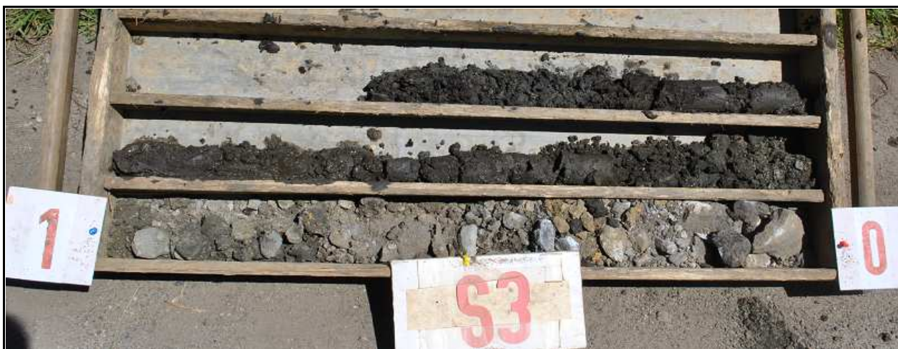
Obr.č. 6 : Pohled na geologický profil sondy S3, hluboké 2,6 m. Cesta je v daném úseku vedena po násypu výšky 0,9 m. Svrchní část tvoří penetrační makadam založený do písčito-kamenité vrstvy, velmi ulehlé (rozpojeno sbíjením) . Násyp spočívá na reliktu hlinitého písku, ulehlém – konzolidovaném, od 1,1 m s vrstvou organogenní zeminy, kypré. Hloubení ukončeno v jílovitém písku, velmi měkké konzistence. Podzemní voda se projevila od úrovně 1,5 m s ustálením 1,65 m pod niveletou cesty.
