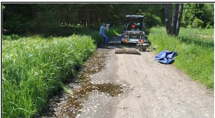
Obr.č. 10 : Pohled na geologický profil sondy S5, hluboké 1,6 m Konstrukce cesty je složena ze silně degradované vrstvy penetračního makadamu s podsypem ze štěrkodrtě 0-32 založené do tmavě šedého štěrkovitého písku , s úlomky cihel (původní povrch cesty) souhrnné mocnosti 0,4 m (rozpojeno sbíjením). Spočívá na vrstvě hnědošedého hlinitého písku , pevné konzistence, s úlomky, od hloubky 0,9 m s přechodem do eluviálně rozvětralého rulového podloží, třídy R6. Hloubení ukončeno ve zcela zvětralé pararule, třídy R6-R5. Podzemní voda se v sondě neprojevila.
