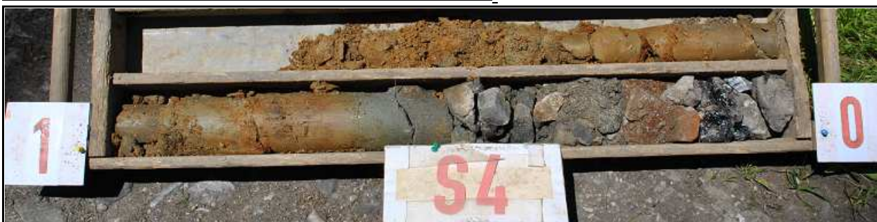
Obr.č. 8 : Pohled na geologický profil sondy S4, hluboké 1,7 m. Konstrukce cesty je složena ze slabě degradované vrstvy penetračního makadamu tl. 150 mm založeném do písčitého štěrku frakce 0-32 celkové mocnosti 0,4 m (rozpojeno sbíjením). Spočívá na vrstvě tmavě šedého písku se střípky cihel (patrně původní povrch cesty) , od hloubky 0,8 m s přechodem do eluviálně rozvětralého rulového podloží, pevnostní třídy R6. Podzemní voda se v sondě neprojevila.
