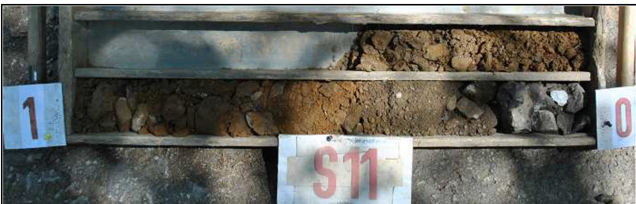
Obr.č. 22 : Pohled na geologický profil sondy S11, hluboké 1,5 m. Konstrukce cesty je složena ze slabě degradované vrstvy penetračního makadamu s podsypem ze štěrkovitého písku, frakce 0-63, mocnosti 0,4 m (sbíjeno). Spočívá na vrstvě rezavého hlinitého písku, pevné konzistence, s úlomky do 50 %, od hloubky 1,0 m s přechodem do silně zvětralé pararuly, velmi málo pevné, třídy R5.
