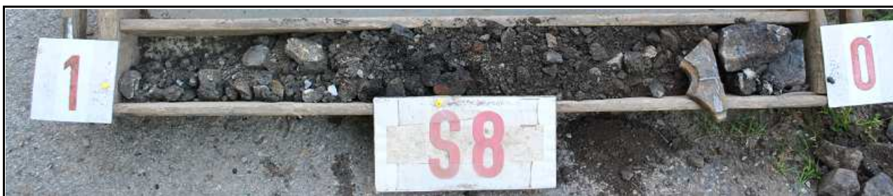
Obr.č. 16 : Pohled na geologický profil sondy S8, hluboké 1,0 m. Konstrukce cesty je složena ze slabě degradované vrstvy penetračního makadamu s podsypem šedočerné písčito-kamenité odpadové vrstvy obsahující kusy litiny . Od úrovně 0,4 m zastižen vyrovnávací písčito-kamenitý násyp, velmi ulehlý, na bázi štětovaný hrubým kamenem, sbíjením neprorazitelné.
